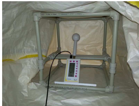
Fot. 2 Widok konstrukcji służącej do badań tłumienia pola elektrycznego wraz z miernikiem Maschek ESM-100 oraz w trakcie badań na stanowisku do sprawdzania mierników (obiekt 6 – klatka z folią budowlaną – wewnątrz)
