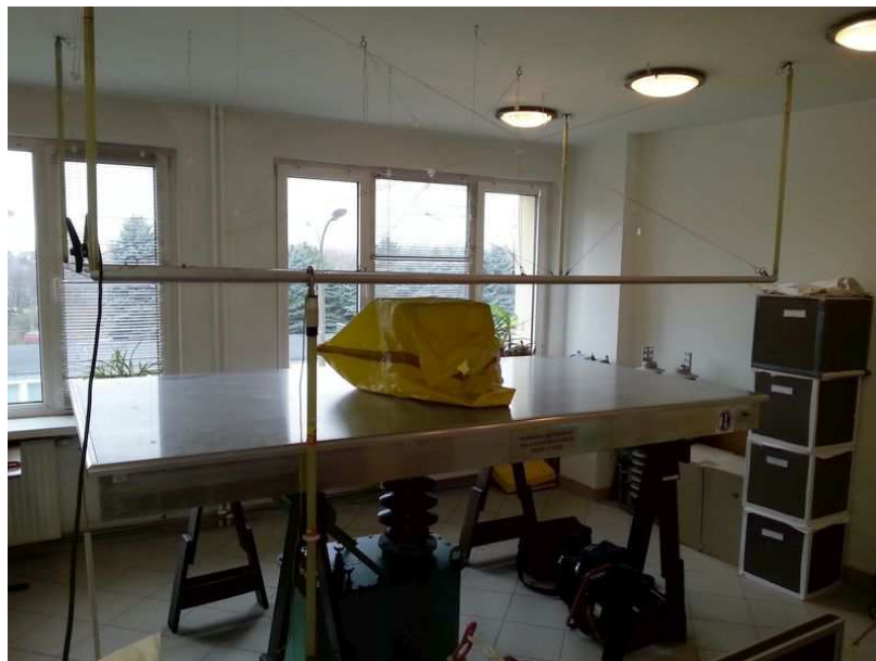
Fot. 1 Stanowisko do sprawdzeń mierników pola elektrycznego 50 Hz
